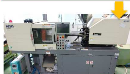
2 射出における樹脂の種類や温度・速さなどの各条件を設定し打ち出しを行います。
