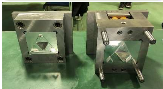
1 製作した金型を射出成形機に取り付けます
