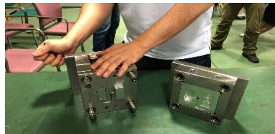
製作した印籠の金型
