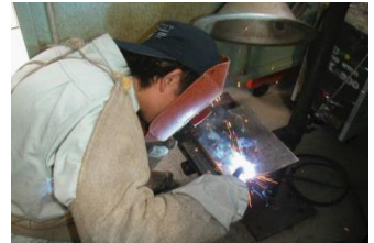
半自動炭酸ガスアーク溶接
