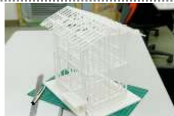
スチレンボードによる軸組模型作成
