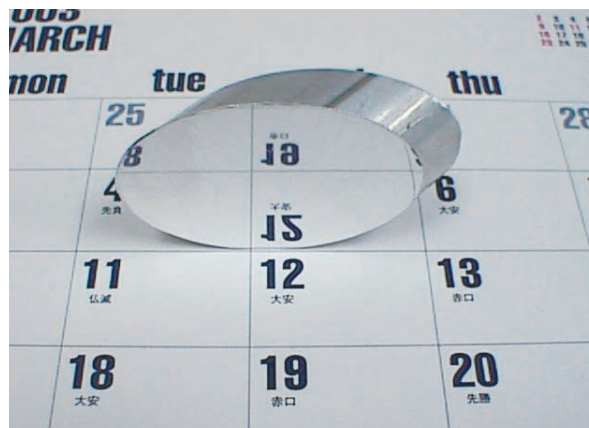
図6 バニシング加工により製作した斜鏡
