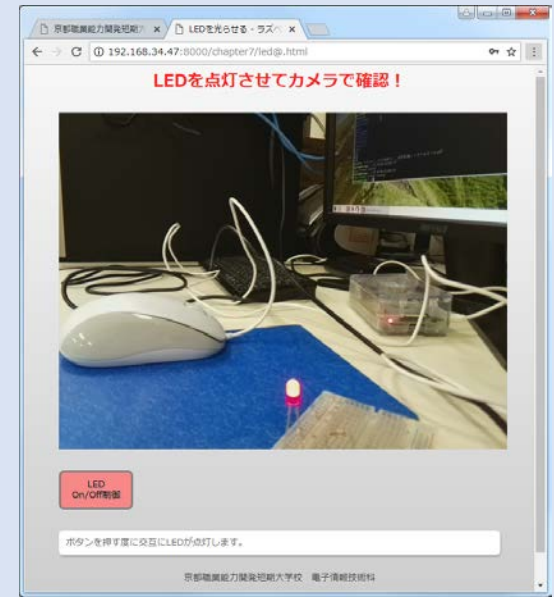
WebブラウザからLEDのON/OFF制御
