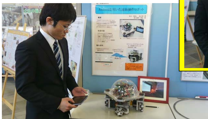
②Android を用いた遠隔操作ロボットの製作
