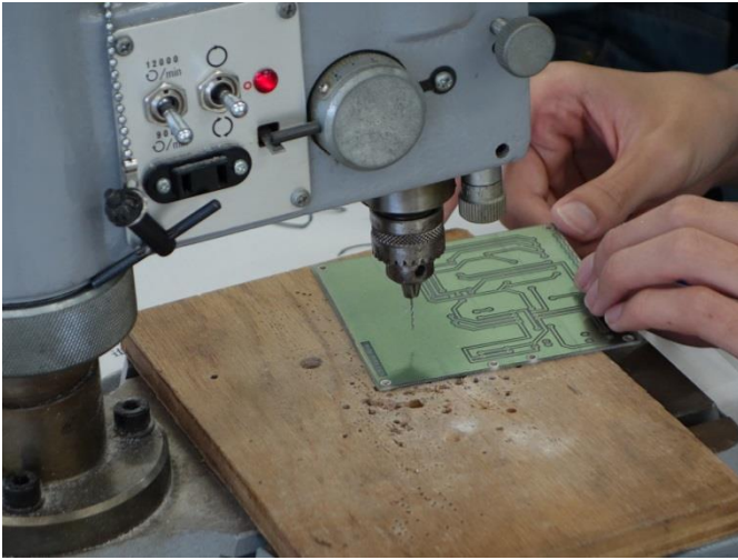
⑨電子部品を差し込むための穴を空ける。 安全には十分注意するぞ！！
